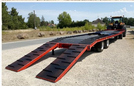
Surface utile : 11m70 x 2m54, Tourelle, RC 235/75 R17.5 Jum., Carré 20 sur plateforme, Cale-Roue...
