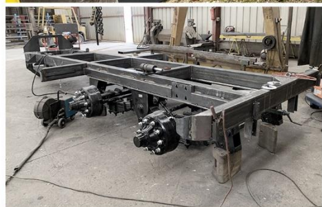
Bras recon., Freinage Mixte, RC 560*60 R22.5 FL630, Anneau boulonné, Prise hydraulique arrière avec coupleurs D.D.S.P. ...
