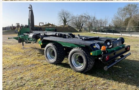
Bras neuf Ampliner, Freinage Mixte, RC 445*45 R19.5, Anneau tournant boulonné, Prise hydro. avec coupleurs D.D.S.P. ...
