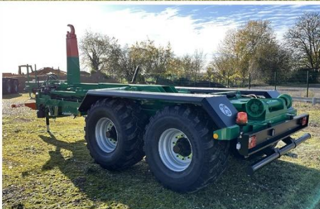
Bras recond., Freinage Mixte, RC 560*60 R22.5 FL630, Anneau fixe soudé, pompe à pistons 80L/min 350b...
