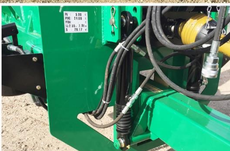
Bras reconditionné, Flèche à suspension hydraulique, suiveur 'Autopiloté', RC 560*60 R22.5 FL630 Sarl BCM - D910 La Normandie - 37110 VILLEDOMER - 02.47.550.100 - www.remorques-bcm.com
