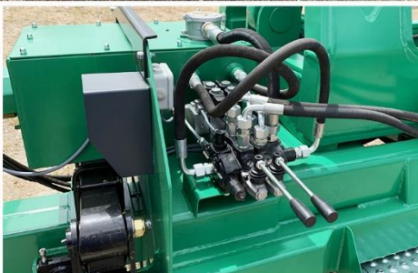
Bras reconditionné, Freinage Hydraulique, RC 385*65 R22.5, Anneau fixe soudé, pompe à pistons 80L/min 350b...
