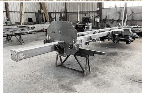
Bras neuf Ampliner, Freinage Mixte, RC 445*45 R19.5, Anneau tournant boulonné, Prise hydro. avec coupleurs D.D.S.P. ...
