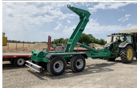
Bras reconditionné, Freinage Hydraulique, RC 385*65 R22.5, Anneau fixe soudé, pompe à pistons 80L/min 350b...
