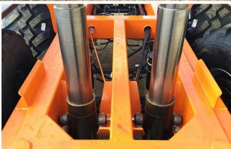
Bras reconditionné, Freinage AIR 40km/h, suiveur 'Classique', RC 560*60 R22.5 FL630, Système élévateur arrière...
