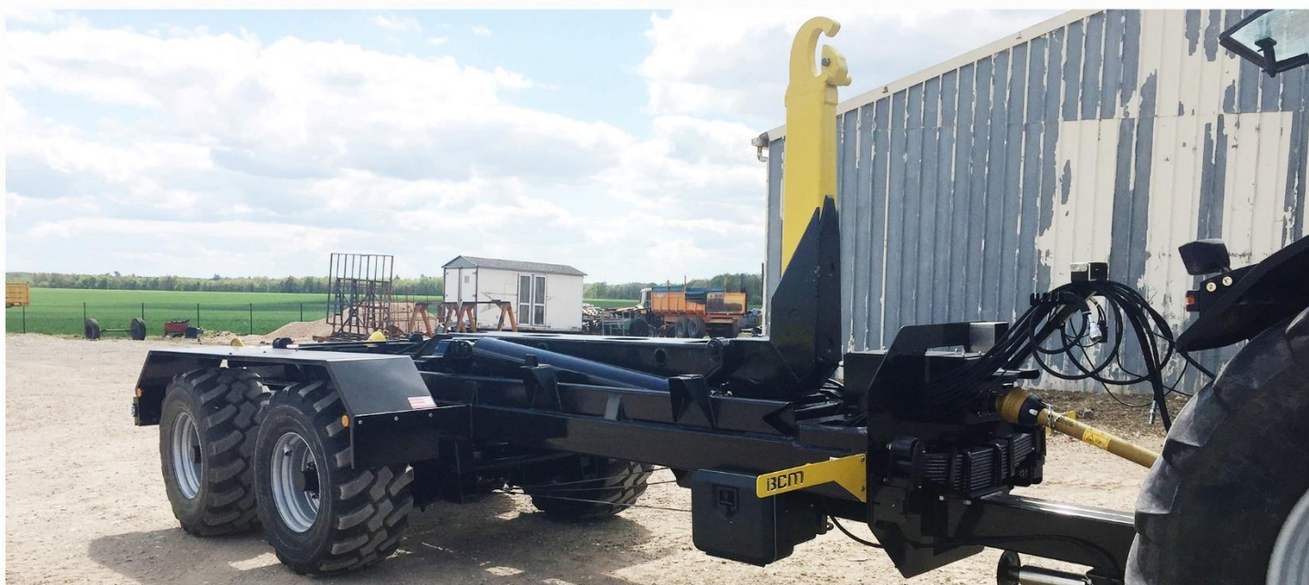
Bras reconditionné, Freinage AIR 40km/h, suiveur 'Classique', RC 560*60 R22.5 FL630, Système élévateur arrière...
