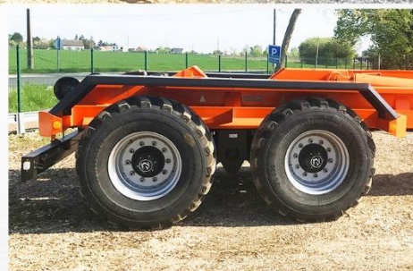
Bras reconditionné, RC 500*60 R22.5 FL630, Rallonge double effet Arr. avec coupleurs DDSP, Sarl BCM - D910 La Normandie - 37110 VILLEDOMER - 02.47.550.100 - www.remorques-bcm.com
