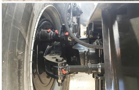
Bras reconditionné, suiveur 'Classique', RC 500*60 R22.5 FL630
