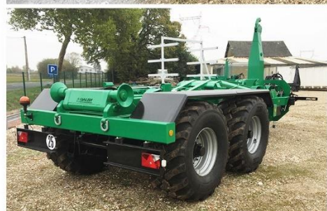
Bras reconditionné, Flèche à suspension hydraulique, suiveur 'Autopiloté', RC 560*60 R22.5 FL630 Sarl BCM - D910 La Normandie - 37110 VILLEDOMER - 02.47.550.100 - www.remorques-bcm.com
