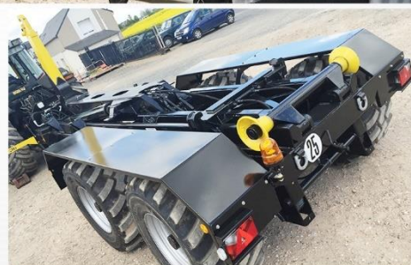
Bras reconditionné, suiveur 'Classique', RC 500*60 R22.5 FL630
