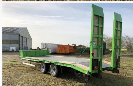
Surface utile : 7m50 x 2m54, Anneau à boulonner, RC 235/75 R17.5, Coffre sur-mesure Av., Bég. Arr. Hydro...
