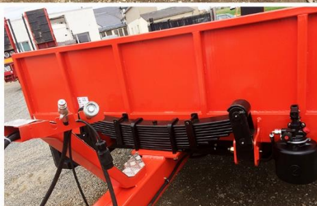
Surface utile : 8m00 x 2m54, Flèche à hauteur décalée, RC 215/75 R17.5 Jum., Face avant pleine...
