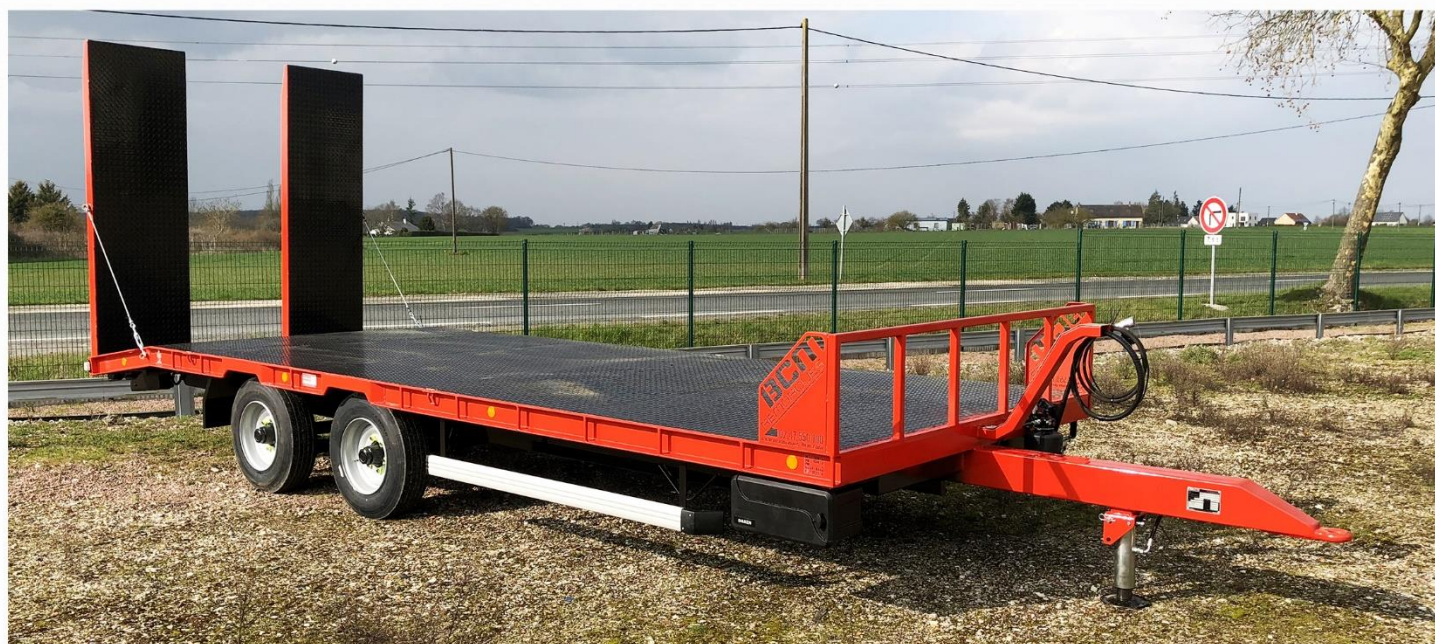
Surface utile : 7m50 x 2m54, Anneau à boulonner, RC 235/75 R17.5, Coffre sur-mesure Av., Bég. Arr. Hydro...
