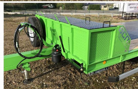
Surface utile : 7m50 x 2m54, Anneau à boulonner, RC 235/75 R17.5, Coffre sur-mesure Av., Bég. Arr. Hydro...
