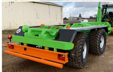
Bras recon., Freinage Air 40Km/h, RC 560*60 R22.5 FL693, Anneau boulonné, Susp. flèche Hydro, suiveur AutoPiloté...
