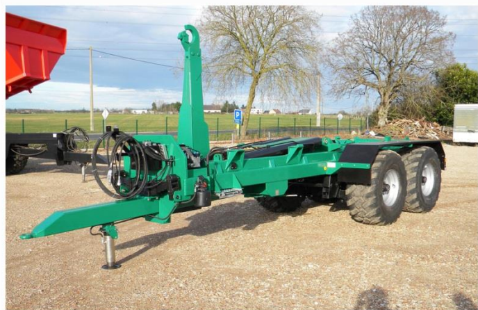
Bras reconditionné, suiveur 'AutoPiloté', RC 560/60 R22.5, Pompe à main sur béquille avant
