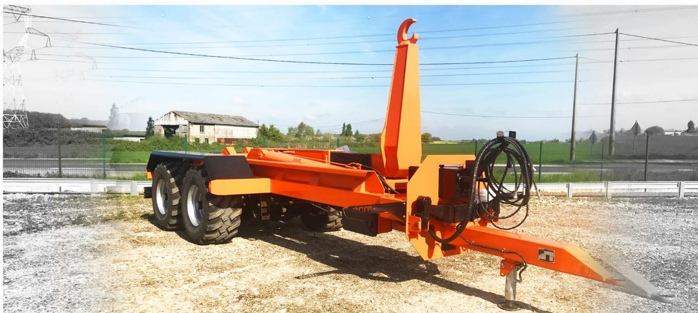
Bras reconditionné, RC 500*60 R22.5 FL630, suiveur arr. 'Classique', Anneau tournant soudé, Support pelle & échelle...
