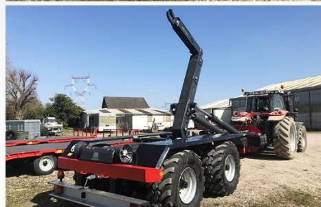
Bras neuf Ampliner, RC 560*60 R22.5 FL630, Essieu suiveur arrière, Potence grande longueur puissance 20T...
