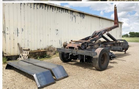
Bras reconditionné, RC 560*60 R22.5 FL693, Anneau boulonné, Prise hydraulique arrière avec coupleurs D.D.S.P. ...
