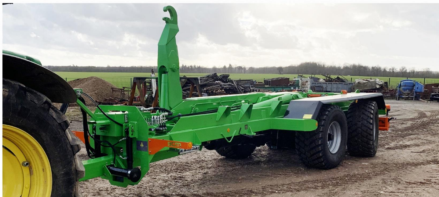
Bras neuf Ampliner, RC 560*60 R22.5 FL630, Essieu suiveur arrière, Potence grande longueur puissance 20T...
