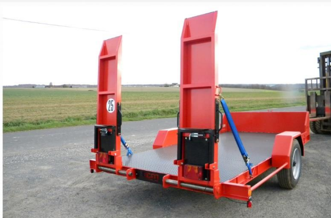
Surface utile : 4m00 x 2m04, Essieu fixe, RC 215/75 R17.5, Fermeture grille avant, Ridelles avant
