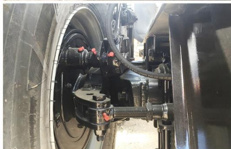
Bras reconditionné, suiveur 'Classique', RC 500*60 R22.5 FL630
