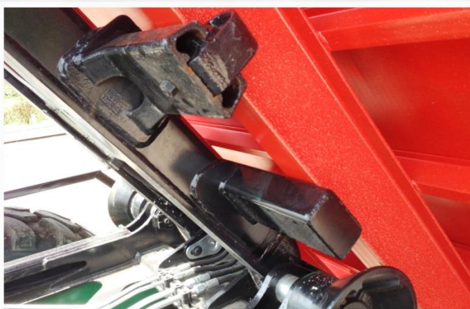
Bras NEUF HIAB, Tuyauterie rigide sur vérin de levage, support berce pour libération effort sur rouleur
