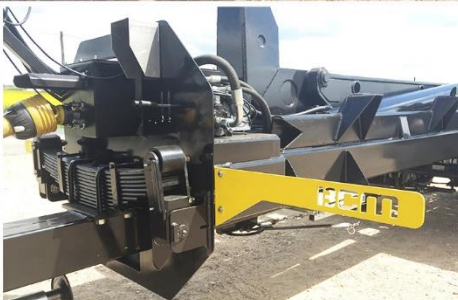
Bras reconditionné, suiveur 'Classique', RC 500*60 R22.5 FL630
