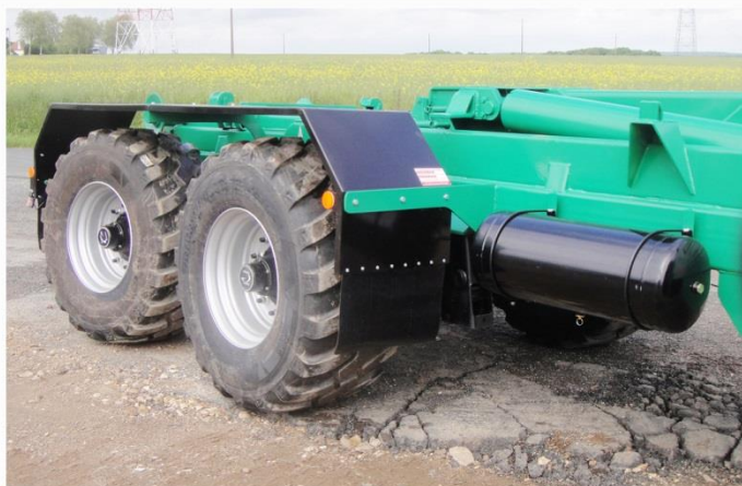
Bras reconditionné, Freinage Mixte 25km/h, suiveur 'Classique', RC 560/60 R22.5
