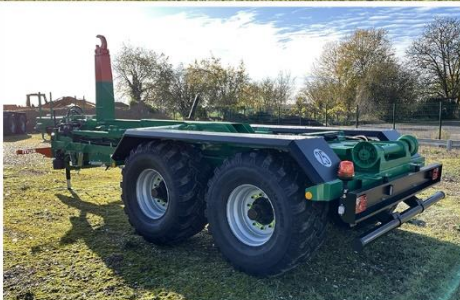
Bras recond., Freinage Mixte, RC 560*60 R22.5 FL630, Anneau fixe soudé, pompe à pistons 80L/min 350b... Sarl BCM - D910 La Normandie - 37110 VILLEDOMER - 02.47.550.100 - www.remorques-bcm.com
